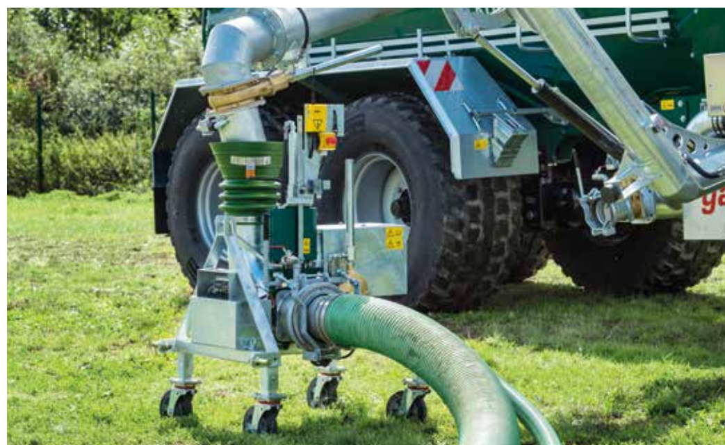
Cône de chargement radio pour réservoirs surélevés et fosses
