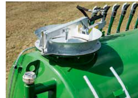
Dôme de remplissage hydraulique avec trappe rabattable pour tonne sous vide
