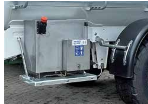
Installation de dosage pour inhibiteurs de nitrification
