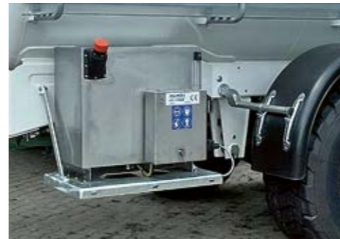
Dosieranlage für Nitrifikationshemmer
