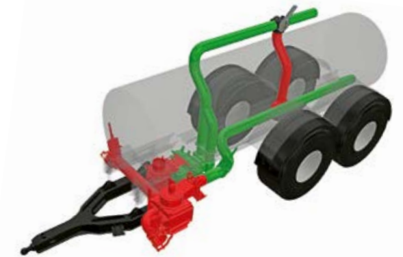
Rohrverlauf beim Pumptankwagen
