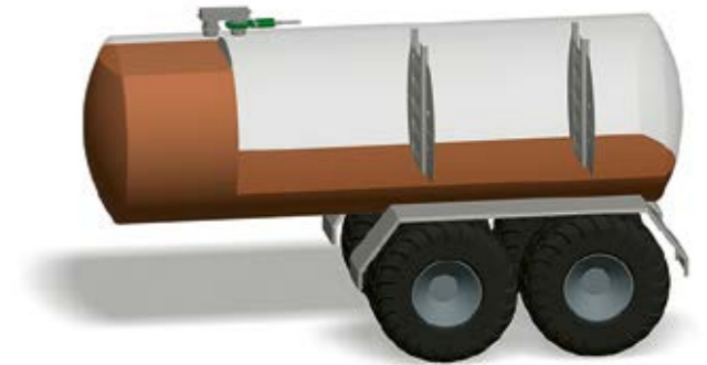
Schwallwände beim Zwei-Kammer-System
