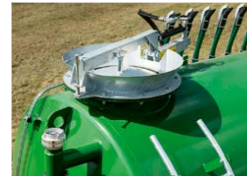
Hydraulischer Einfülldom mit Klappdeckel für Vakuumtankwagen
