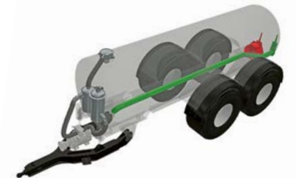
Rohrverlauf beim Vakuumentankwagen
