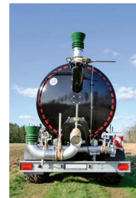
Andockvorrichtung für Zubringer unten am Mannlochdeckel
