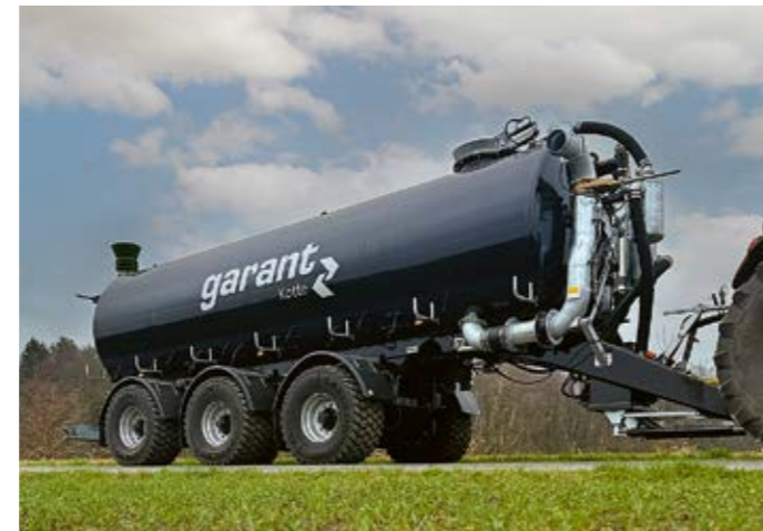
TASD mit 1 DG Seitensaugarm und hydraulischem Klappdeckel
