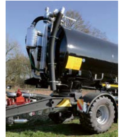
Mechanisch angetriebener Kompressor mit Drehdurchführung
