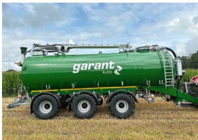
TASD mit Überladerohr und hydraulischem Klappdeckel
