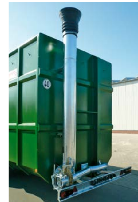
Andockvorrichtung am Feldrandcontainer
