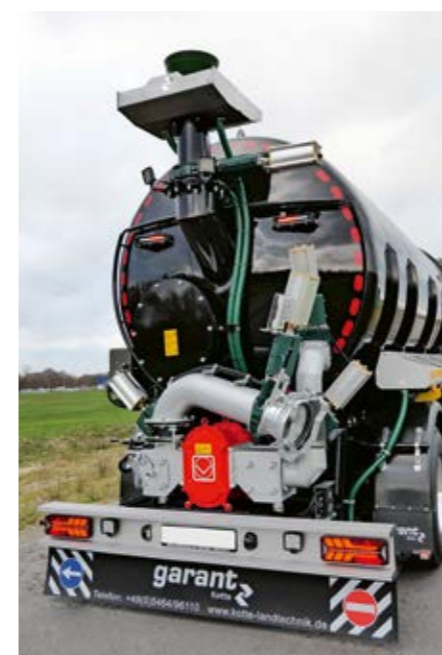
Andockvorrichtung für Zubringer oben an der Behälterrückwand
