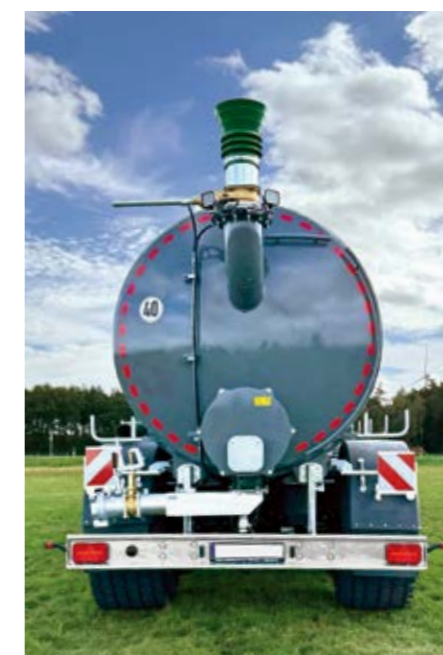
Andockvorrichtung für Zubringer oben an der Behälterrückwand
