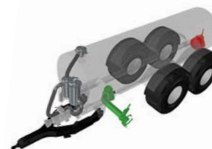
Funktionsprinzip „Befüllen“ Vakuum-Güllewagen
