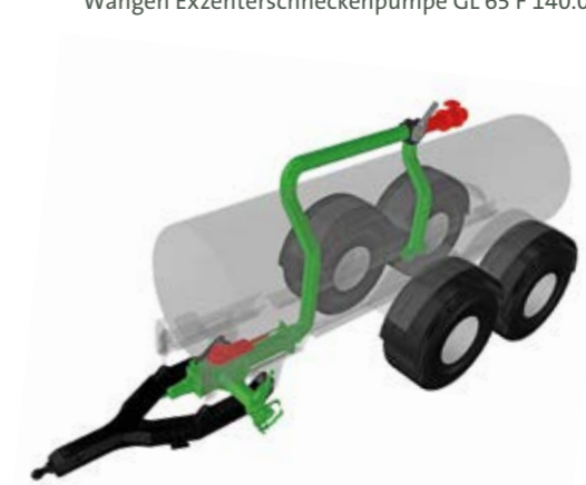
Funktionsweise „Befüllen“ mit Excenter TopFlow
