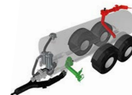
Funktionsprinzip „Befüllen“ Vakuum TopFlow
