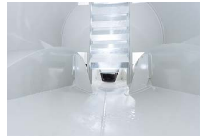
Verschraubte Schwallwände, verstärkte Radkästen sowie 2K Epoxid-Harz-Innenbeschichtung
