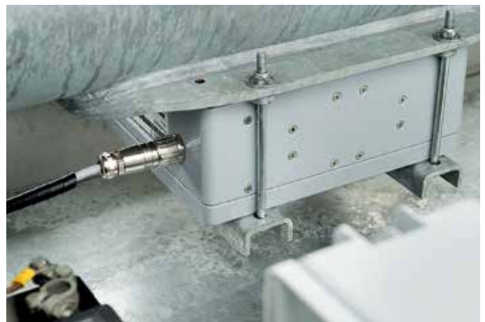
Der NIRS-Sensor misst online die Anteile von Gesamtstickstoff, Ammoniumstickstoff, Phosphor, Kalium und Trockensubstanz.
