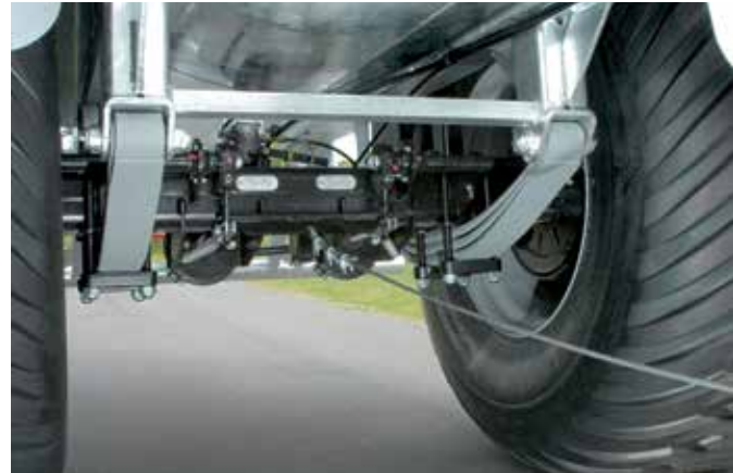
Niedrige Bauweise durch Federung unterhalb der Achse
