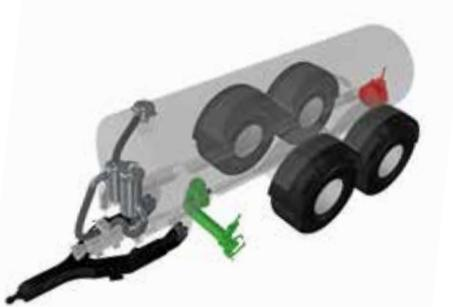
Principe de fonctionnement « remplissage » de la tonne à lisier avec dépression
