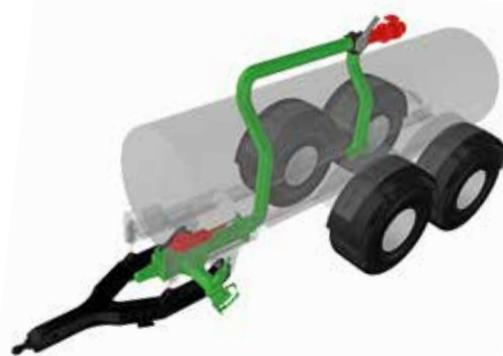
Mode de fonctionnement « remplissage » avec Excenter TopFlow
