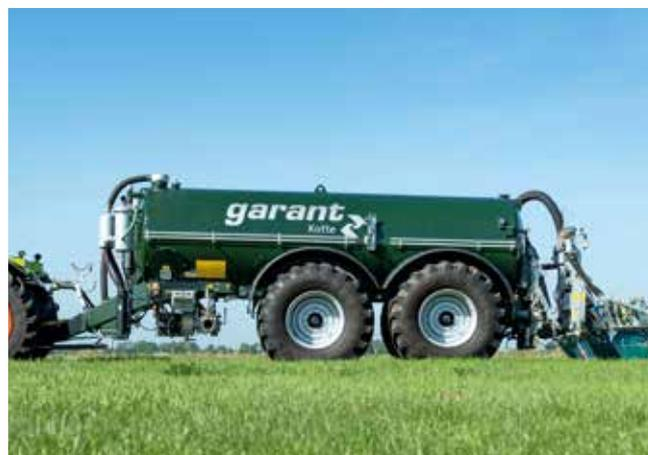
Cuve peinte avec protection en résine Epoxy intérieure
