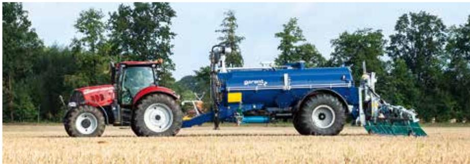
Tonne à lisier en tandem de 8 à 21 m<sup>3</sup>
