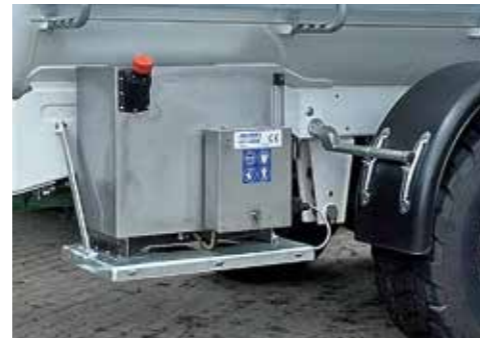
Dosieranlage für Nitrifikationshemmer
