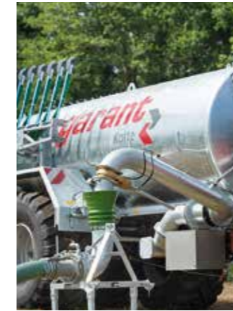
Saugrüssel mit einem Drehgelenk
