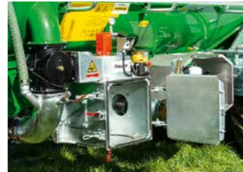
Schneidwerkseinrichtung mit Steinfangkasten
