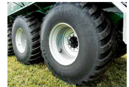
PTG Reifendruckregelanlage mit Zwei-Leiter-System
