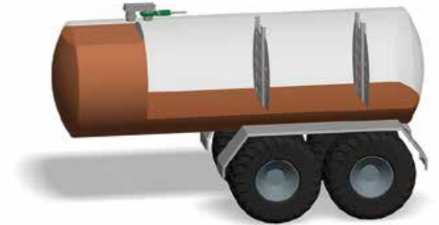
Schwallwände beim Zwei-Kammer-System
