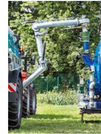
Saugrüssel mit zwei Drehgelenken
