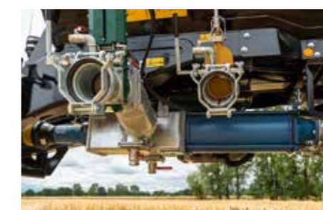
Wagen Exzentrerschneckenpumpe GL 65 F 140.0
