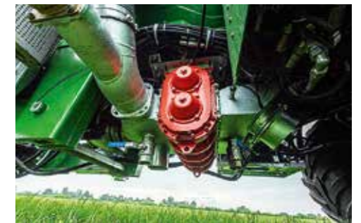
Drehkolbenpumpe beim TopFlow-System
