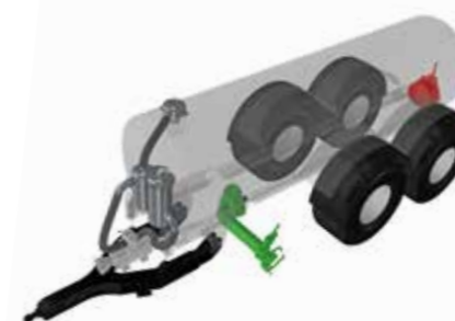
Funktionsprinzip „Befüllen“ Vakuüm-Güllewagen
