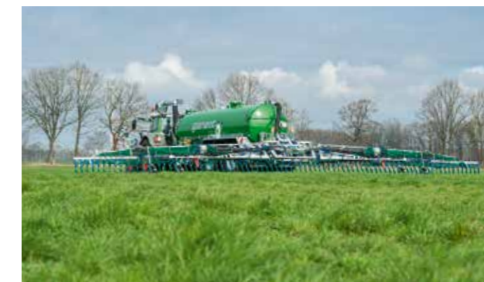
BOMECH Schleppschuhverteiler Multi 21 m
