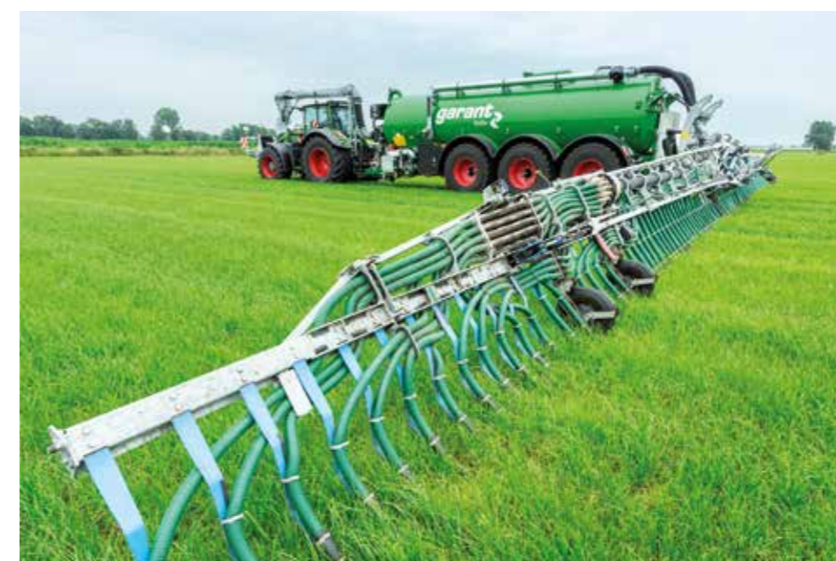
BOMECH Schleppschuhverteiler – durchkonstruiert und dank aktivem Druck besonders nährstoffeffizient.
